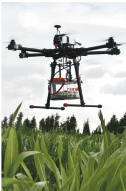
Pokaz aplikacji biopreparatu przy użyciu drona na polu doświadczalno-wdrożeniowym LODR w Pożogu II fot. A. Jakimiak
